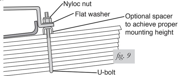
**SECURING THE AIR SPRING TO BRACKETS**
